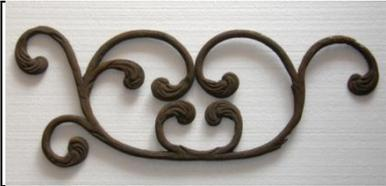
La **grille en fer forgé** a été assemblée vers 1550 en utilisant la plus ancienne technique de soudage, le soudage au feu, elle provient de la fenêtre de la tour du château de Zell.
